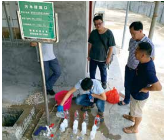
在大亚湾电路板厂现场抽验水质样本
